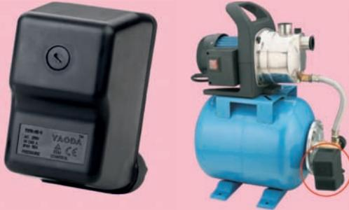
Реле давления предназначено для автоматизации работы электронасоса или станции, включая его при понижении давления (открытие кранов) в системе водоснабжения ниже установленного предела, и отключая электронасос при достижении верхнего установленного предела (закрытие кранов). Присоединительный размер - 1/4" (внутренняя резьба)
