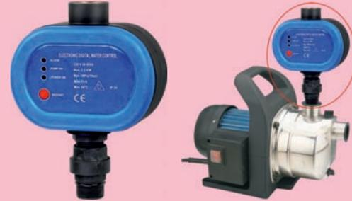
Гидроконтроллер предназначен для включения и выключения электрических насосов. Кроме того, также отключает насос при отсутствии потока воды в системе, что предотвращает работу оборудования без воды. Время срабатывания защиты по «сухому ходу» - от 7 до 15 секунд. Используется с любыми типами центробежных насосов.
